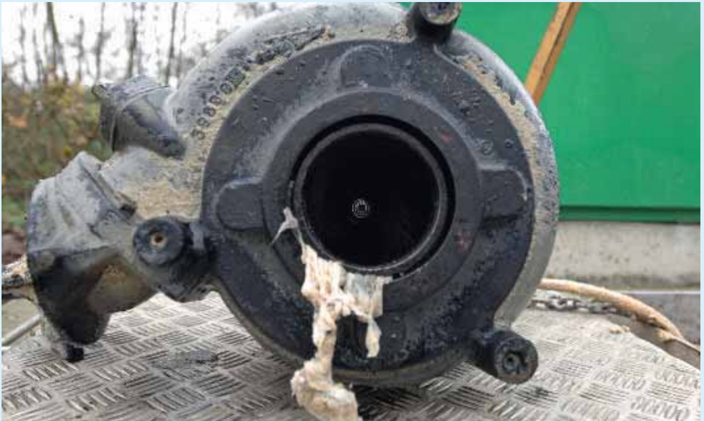
Pompstoringen, onder andere door verstoppingen, zorgen gemiddeld voor een toename van de jaaremissie met 15 procent (foto: Stichting RIONED/bv Beeld).
