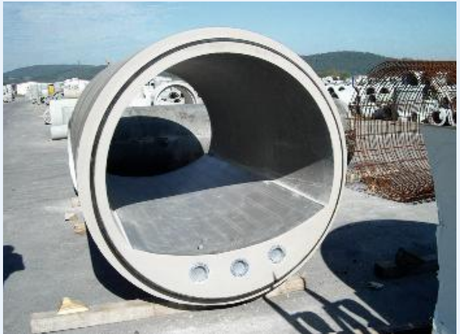
Warmtewisselaar geïntegreerd in rioelbuis (bron: Rabtherm).
