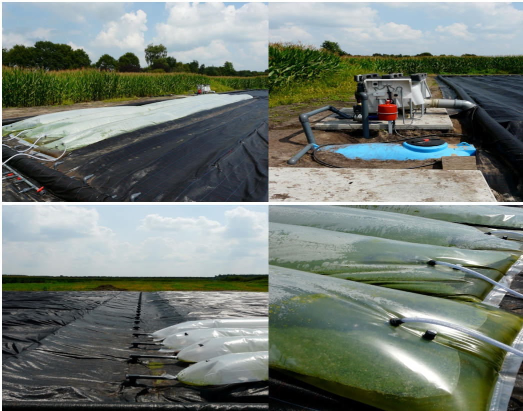
Figuur 3. Teelt van eendenkroos Algaecom: Linksboven: Teelt in plastic zakken, Rechtsboven: Mengvat waarin o.a. spoelwater terechtkomt en waarin nutriënten en water worden toegevoegd, Rechtsonder: Luchtinlaat teeltzak, Linksonder: Uitlaat zakken naar verzameldrain.
