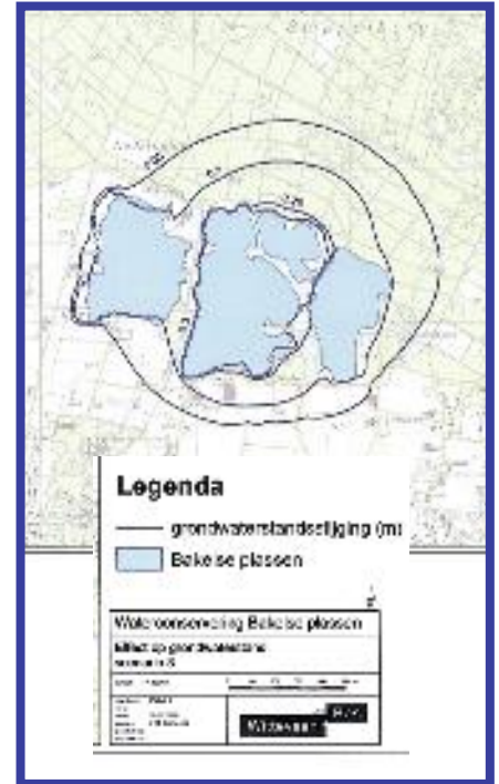
Afb. 5: Effect inlaatscenario 3 (30 l/s gedurende een periode van 4,5 maanden) op het grondwaterpeil in de directe omgeving van de plassen.
