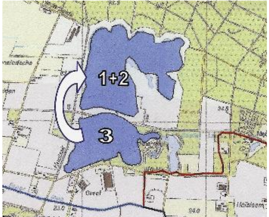
Afb. 2: Overzicht onttrekking uit plas 3 (peilverlaging) en conservering in plas 1 + 2 (peilverhoging).
