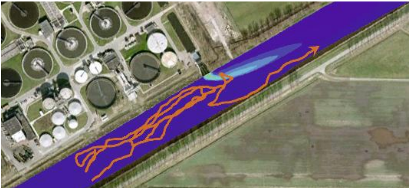
Afb. 3: Een met een zender uitgeruste schieraal wijzigt meerdere malen zijn zwemroute (oranje lijn) bij nadering van de lozingspluim uit rwzi Garmerwolde in het Eemskanaal alvorens langs de rand van de lozingspluim te passeren. De gemodelleerde positie van de lozingspluim is op het moment van de passage weergegeven (lichtblauw).
