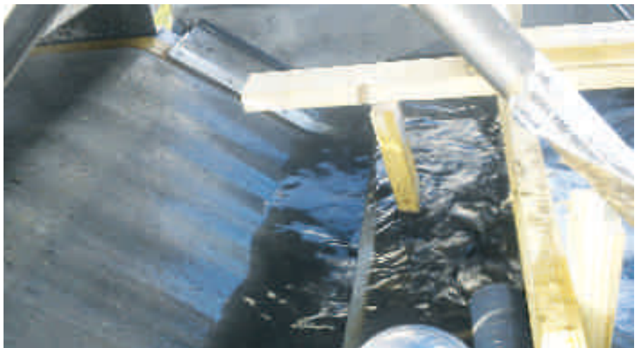
Testopstelling toevoer surpluslib in fijnzeef.
