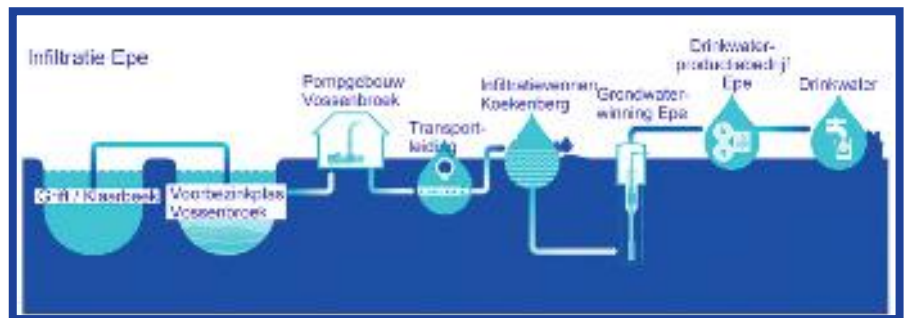
Afb. 2: Werking van de infiltratie bij Epe.
