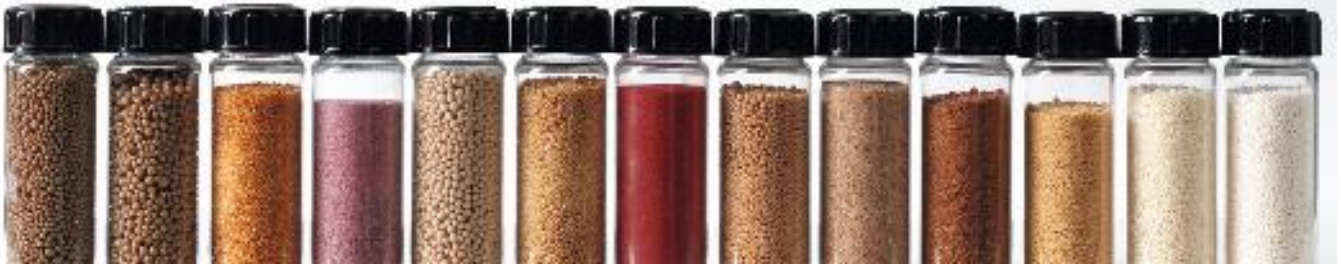
Kalkkorrels van verschillende Nederlandse installatie's.
