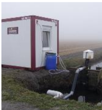
Pilotopstelling bij stuwteje in Egmond (container, reactor en bovenaanzicht elektrocoagulatiereactor).
