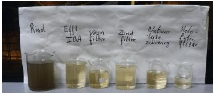
Visueel resultaat van de zuiveringsstappen met het veenfilter in de proefopstelling bij Van Hall Larenstein te Leeuwarden.
