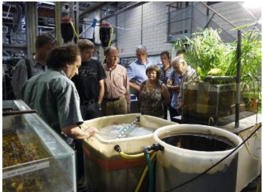
Proefopstelling van het veenfilter in combinatie met het zandfilter.
