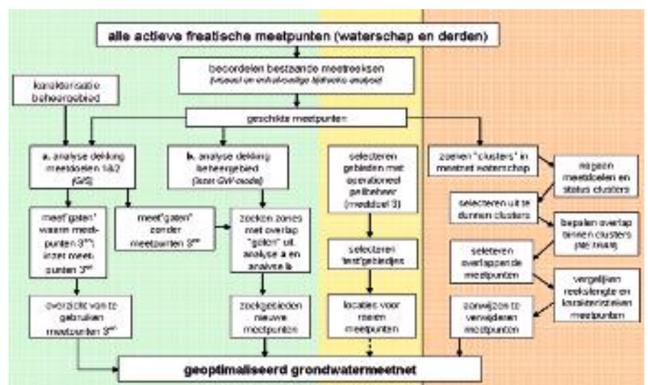
Afb. 1: Schematisch overzicht van de in deze studie gevolgde werkwijze. De technieken die gebruikt zijn bij bepaalde onderdelen van de analyses zijn aangegeven tussen haakjes.
