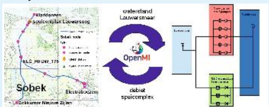
Afb. 1: Opzet van het volgens de OpenMI-standaard gekoppeld systeem uit een Sobek- en een Wanda-model en uitwisseling van modelresultaten.
