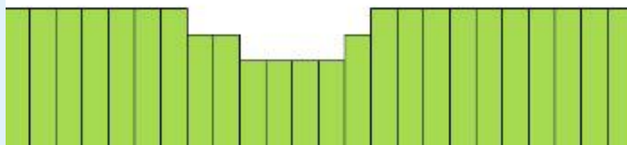
Afb. 3: Zijaanzicht van een binnenkering met een lokale laagte (boven), met daaronder aangegeven hoe dit zijaanzicht eruit komt te zien in een opgeschaald hoogtemodel met een grof detailniveau (hoogste waarde, of kleinste waarde) en een fijn detailniveau.
