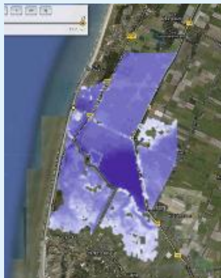
Afb. 1: Overstromingsbeeld twaalf uur na de doorbraak bij een variatie in de duur van de verticale bresgroei. Duur verticale bresgroei een half uur.
