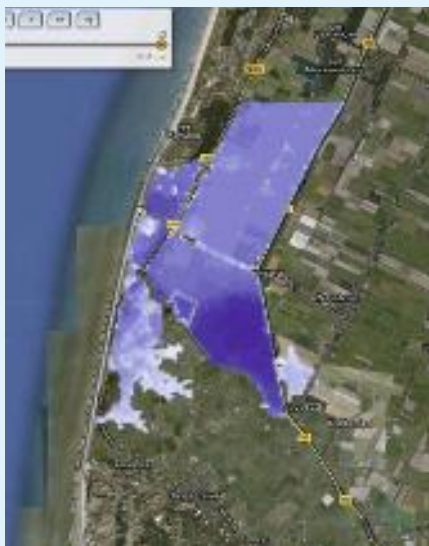
Afb. 1: Overstromingsbeeld twaalf uur na de doorbraak bij een variatie in de duur van de verticale bresgroei. Duur verticale bresgroei een half uur.
