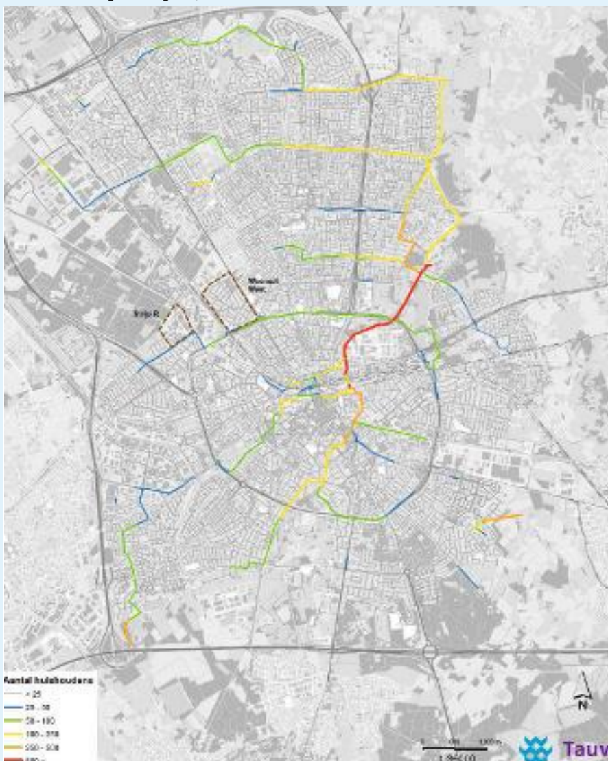
Afb. 4: Aantal huishoudens in Eindhoven die met riothermie verwarmd kunnen worden (rekening gehouden met afvalwaterafkoeling van één graad).
