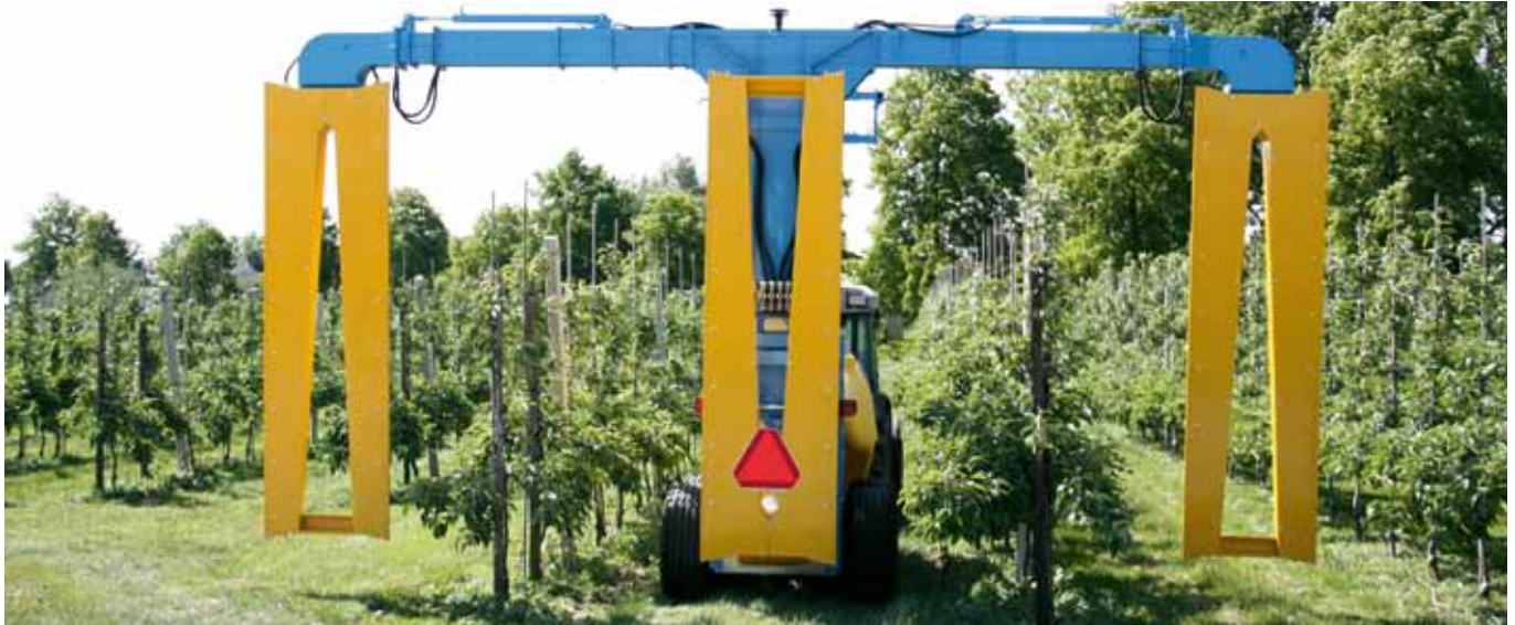
Met behulp van een sensor die windsnelheid en -richting meet, zorgt deze spuit voor een 'variabele luchtuitgifte' naar links en rechts. Tegen de wind in wordt meer lucht gebruikt en met de wind mee minder. Hierdoor vermindert de verwaaiing van het bestrijdingsmiddel met 95%.
