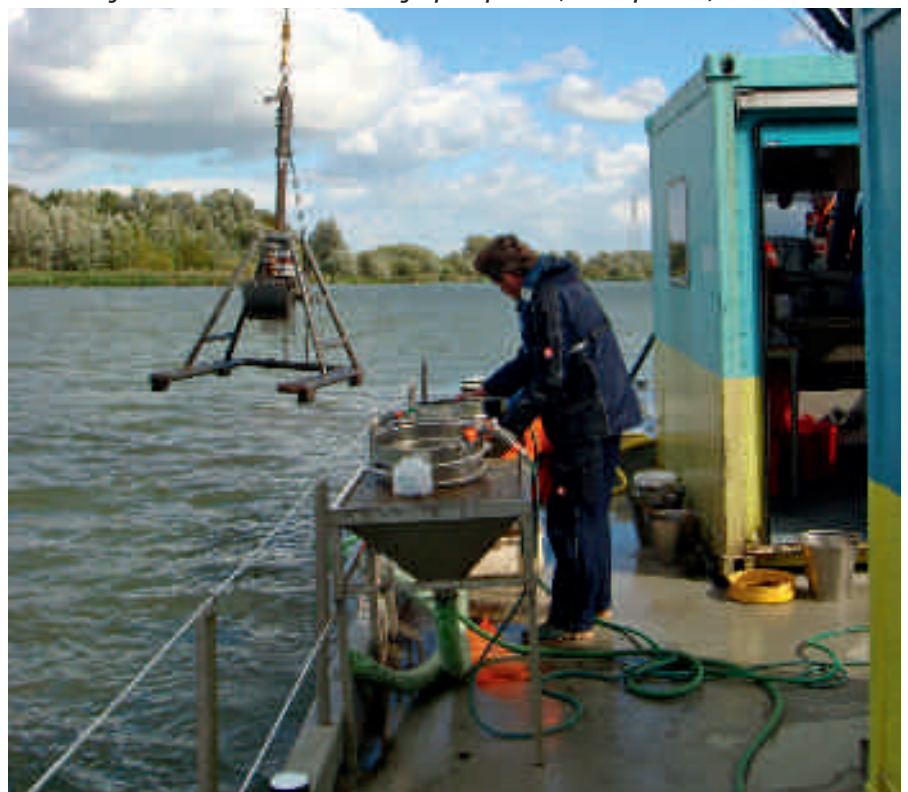
Bemonstering met een Boxcore in de Biesbosch afgelopen september (foto: Jaap Postma).
