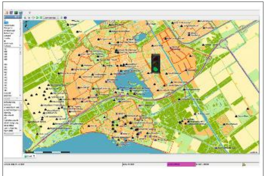
Afb. 1: Het functioneren van het afvalwaterstelsel kan grafisch worden weergegeven op een kaart door gemalen en persleidingen verkeerslichtkleuren te geven.
