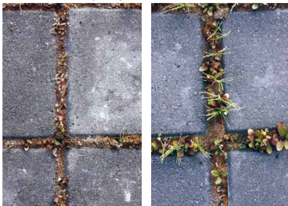
Figuur 4 – Invloed van voegbreedte op onkruidbedekking. (zuiver zeezand, 3 mm vs. 11 mm voeg).
