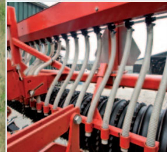
25 buizen verdelen het zaai­zaad over een breedte van 3 meter.
