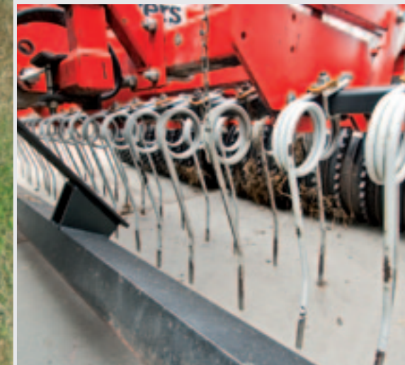
De egalisa­tie­balk maakt de grond vlak, waarna de wiede­g de grond los­maakt en het onkruid en ondiep wortelende gras­sen ver­wij­dert.
