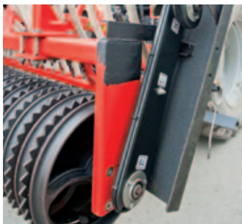
De metalen plaat beschermt de plastic kettingkast.
