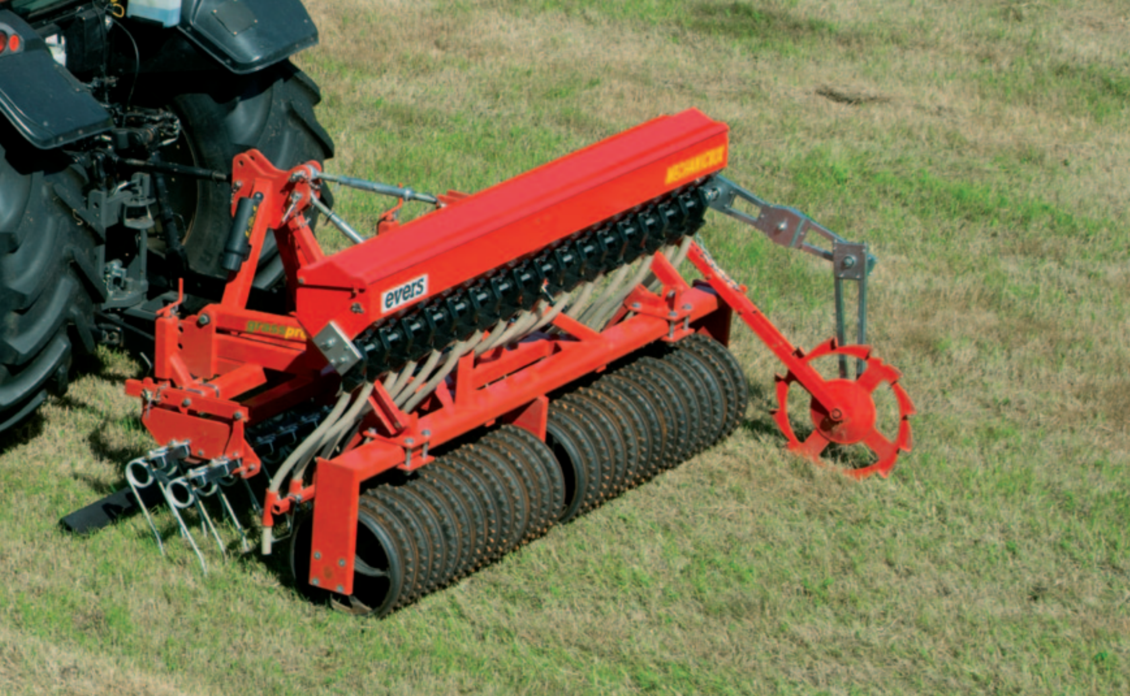
25 buizen verdelen het zaai­zaad over een breedte van 3 meter.
