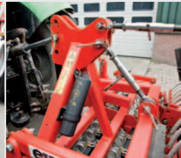
Met top­stan­gen kun je de hoogte van de cambridge­rol en van de zaai­ma­chine ver­stellen.
