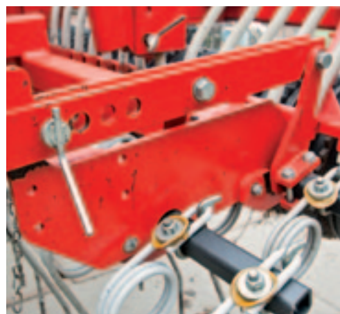
Het mechanisme dat het mogelijk maakt om de wiedeg voor- of achterover te kantelen.
