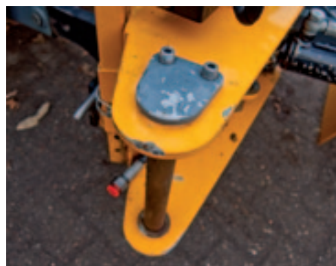
De arm die de kantensnijder draagt kan met een pin links en rechts worden bevestigd.
