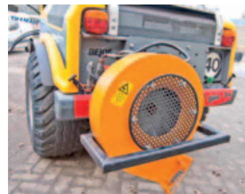
Met een hydraulische bladblazer kan een machine snijden, borstelen en het afval terugblazen.
