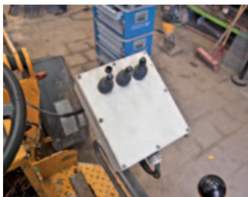
Als het aantal ventielen beperkt is, kun je kiezen voor elektrohydraulische bediening.
