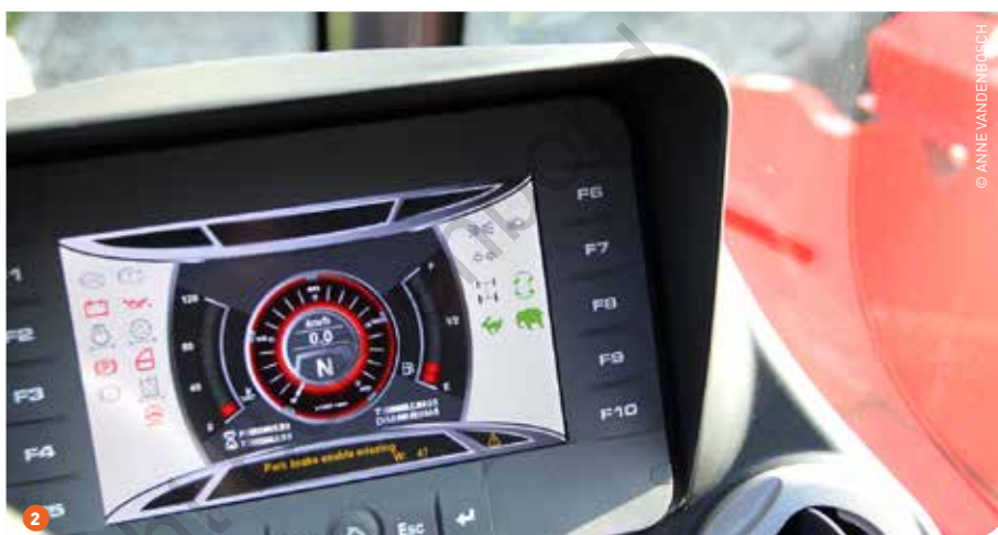
1 De nieuwe MLT 732 is ideaal voor kleinere bedrijven die toch grotere handling-werkzaamheden, zoals het verplaatsen van grote ronde balen, moeten uitvoeren. 2 De nieuwe modellen van Manitou krijgen een nieuw innovatief scherm. Naargelang de werkzaamheden veranderen de gegevens die in beeld komen.
