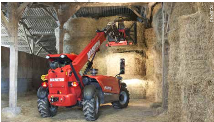
Manitou verhoogt het comfort op de MLT 625 door demping van de hefarm. Het systeem kan al rijdend ingeschakeld worden bij iedere hellingshoek van de telescoop. Het schakelt bovendien automatisch uit bij lage snelheid.
