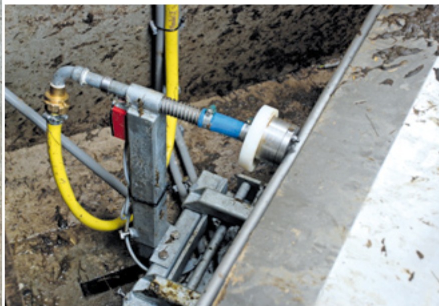
Water stroomt via een kogelklep in de twee tanks van de JOZtech. Zodra de tanks vol zijn geeft een sensor het signaal om de watertoevoer af te sluiten.
