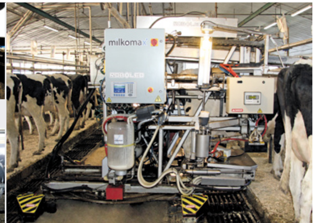
Tijdens het melken stapt de koe 30 cm naar achteren. Ze stapt dus vanaf de stand in de melkrobot. De robot draait, schuift naar voren en overbrugt de mestgrup.
