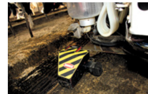
De vier wielen onder de robot volgen een metalen strip op de vloer van de centrale mestgang.
