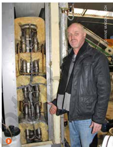
1 De installatie op het bedrijf Lavens is uniek. De groenten en aardappelen belanden vanuit een vast opgestelde kiepwagen (oranje) in de waszone (groen). Via een voortdraaiende mat komen de gewassen ingrediënten in een vijzel met op het eind een versnijder (blauw) terecht. 2 "De verpompbare groentebrij wordt via een buizensysteem (70 m) doorheen een warmtewisselaar gestuurd", toont Geert Vermeulen. "Dat is onze kookpot. Ongewenste kiemen worden afgedood door pasteurisatie. De temperatuur stijgt immers tot 90 à 100 °C." 3 De brij wordt vervolgens naar een geïsoleerde tank verpompt waar lactobacillen voor fermentatie zorgen. Ze breken de koolstofcomplexen af en het eindproduct wordt smakelijker en beter opneembaar. De gefermenteerde groentebrij belandt uiteindelijk in de voorraadbunker (links) en is klaar voor inmenging in het varkensvoer.
