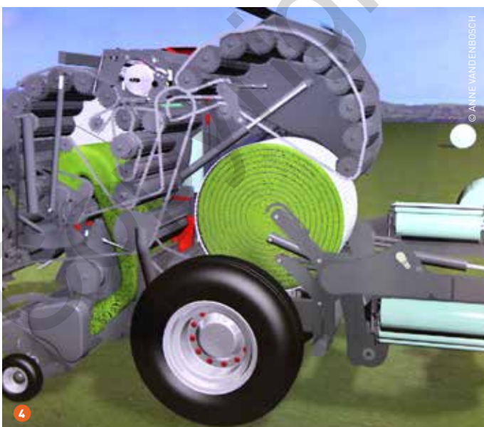
1 De Claas-cabine met overloopdakvenster kreeg door zijn eenvoud en veiligheid een gouden SIMA-medaille. 2 Met de precisiezaaimachine Exact-Emerge van John Deere kan je aan een zeer hoge snelheid (16 km/uur) toch nauwkeurig zaaien. 3 Berthoud won zilver met de B-safe, een tool om veiliger gewasbeschermingsproducten in de spuitmachine te brengen. 4 De Vicon Fastbale combineert het non-stop persen in 2 kamers met rollen en het omwikkelen in één enkele activiteit. 5 Massey-Ferguson toonde in première de 7700-serie. Deze vervangt de 7600-serie en bestaat uit 9 modellen.
