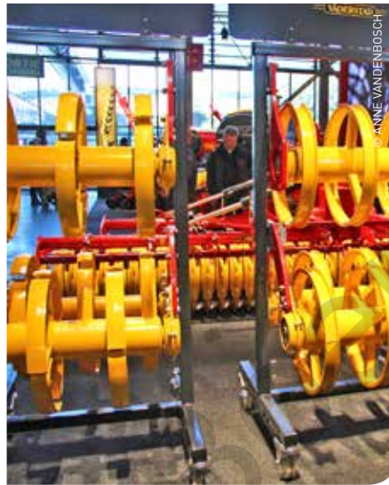
De Carrier-serie van Väderstad kan uitgerust worden met diverse rollen. De nieuwe TopRunner is geschikt voor het zaaiklaar leggen van lichte gronden. Bij zwaardere gronden is een 'open' SoilRunner (rechts) beter.
