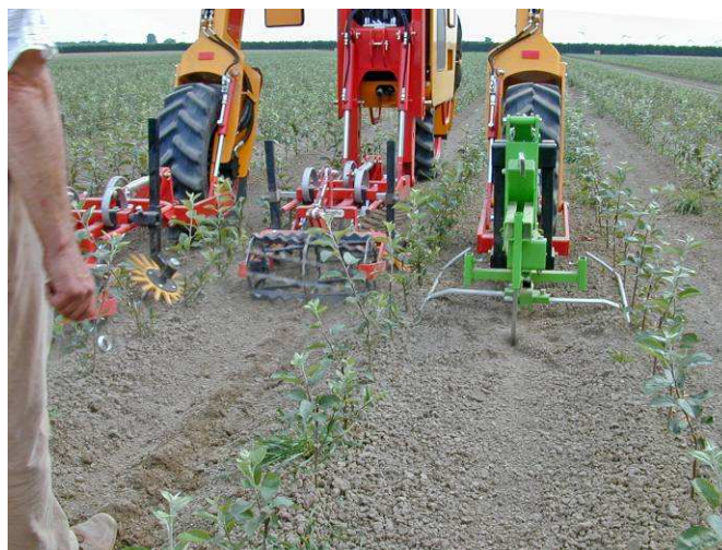
De afgelopen jaren zijn veel verbeteringen bereikt in de mechanische onkruidbestrijding; hier een demonstratie op een vruchtbomkwekerij met verschillende schoffelsystemen.
