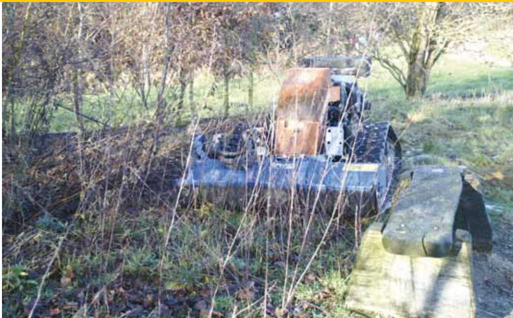
Wolterinck verving bosmaaiers door de radiografisch bestuurbare klepelmaaier.
