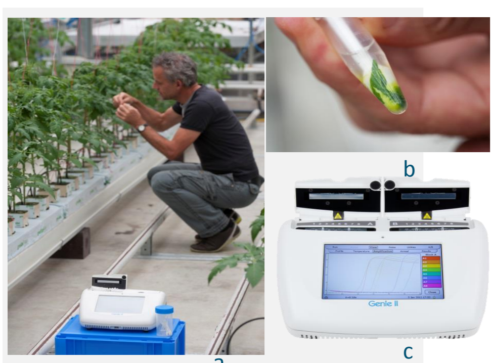
Figuur 2. On-site detectie in de kas: a) nemen monster b) homogeen maken plant extract c) On-site analyse met Genie II apparaat
