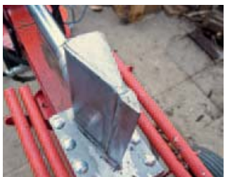
■ Het mes beweegt met glijplaten over een H-balk. Dat kan in de stand 'schildpad' of 'haas'.
