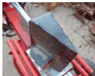
■ Het kruismes, om blokken direct in vieren te splitpen, schuift je over het vaste mes.
