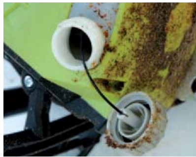
Een verhoogde opening en een dubbele rand in de dop (zoals hier bij de Ryobi) gaan morsen van olie tegen. Wel smeerde de Ryobi de ketting ruimhartig. Vandaar de vervuiling.
