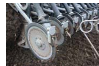
▲ Kongskilde De Kongskilde Ecoline zaait met een enkele schijf. De machine legt het zaad aan de bolle zijde van de schijf af.
