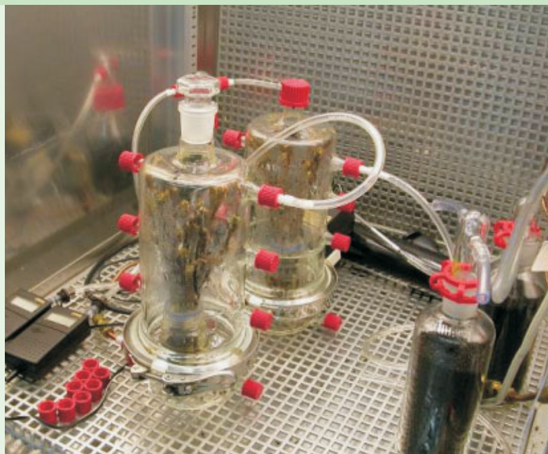
Appelbloesemkevers met appeltakken onder een stolp. De geproduceerde geuren worden verzameld en na scheiding over de keverantennes geleid voor identificatie van de aantrekkelijke componenten.
