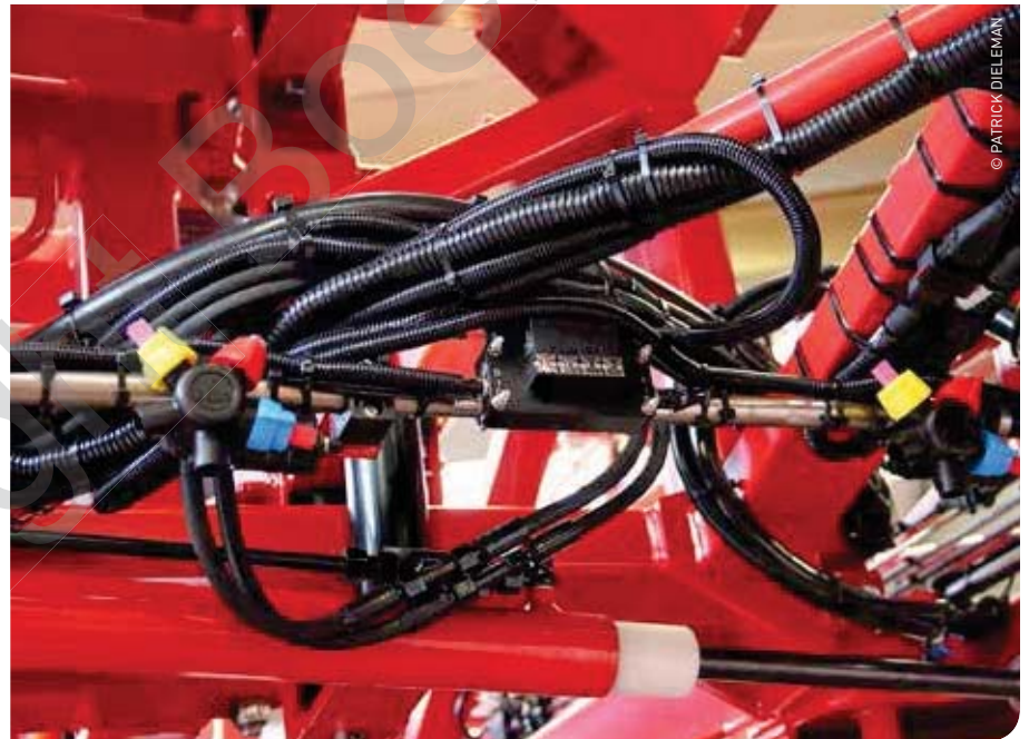
De nieuwe Python kan worden uitgerust met een systeem dat elke dop afzonderlijk afsluit, in plaats van per sectie. Dat maakt precisielandbouw nog een stukje preciezer.
