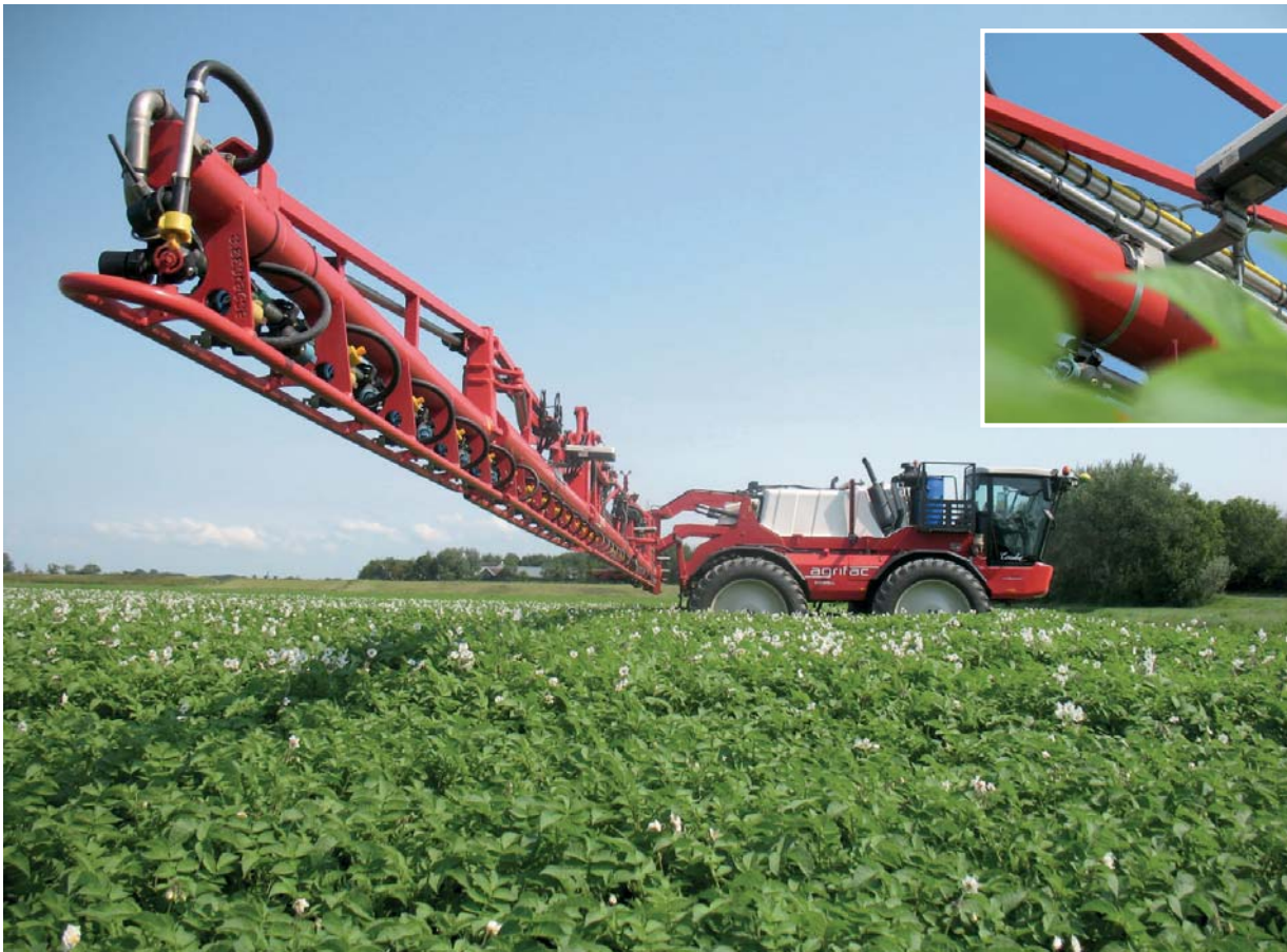
Sensoren aan de bomen van de veldspuit meten de gewasreflectie. De kunst is om de gemeten waarden te vertalen naar de werkelijke bemestings situatie. Daar gaat voorlopig veel tijd in zitten.
