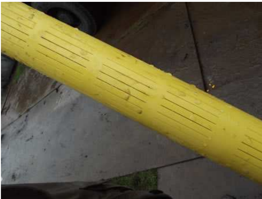
het onderste gedeelte van de pijp is geperforeerd
