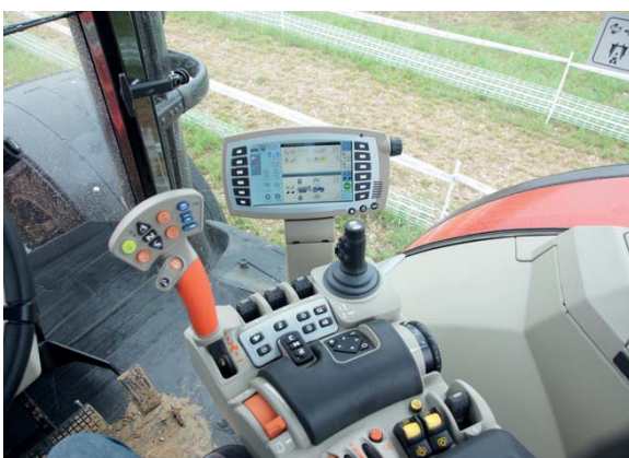
Het nieuwe bedieningscentrum met links de joystick die ook op andere modellen al te vinden is.
