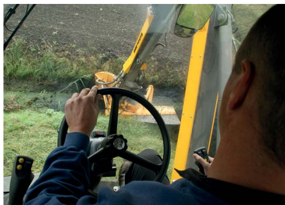
Eén hand aan het stuur, de andere aan de joystickbediening en goed zicht op het werk bij een rechte zit. Arbotechnisch heel veel beter dan een trekker met aanbouw-slotenreiniger.
