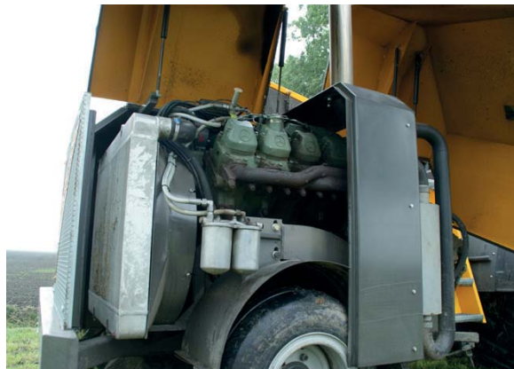
Heel apart is dat de complete motor met pompunit als contragewicht in hondengang extra ver naar buiten steekt. De Excentriek heeft een overbemeten Mercedes-V8-kraftbron en flinke pompen.
