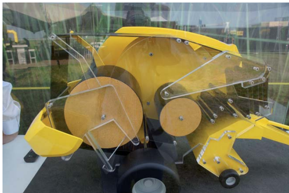
In dit openge- werkte model is te zien hoe de riem door de pers loopt en hoe een nieuwe baal wordt opgebouwd terwijl bij de andere de netbinding plaatsvindt.
