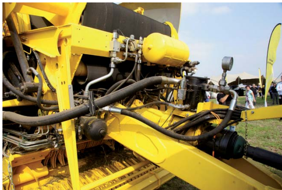
De pers heeft een eigen hydraulisch circuit voor de aandrijving van alle componenten.
