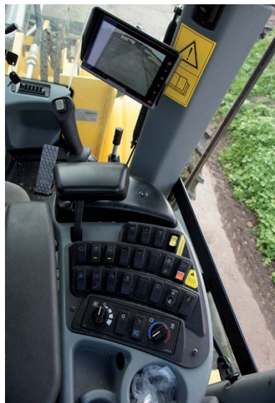
Alle knoppen zitten in een overzichtelijk paneel bij elkaar. Optioneel is ook de driehendelbediening zoals deze in de Volvo-shovels zit, met een joystickbesturing in de linker armluning.
