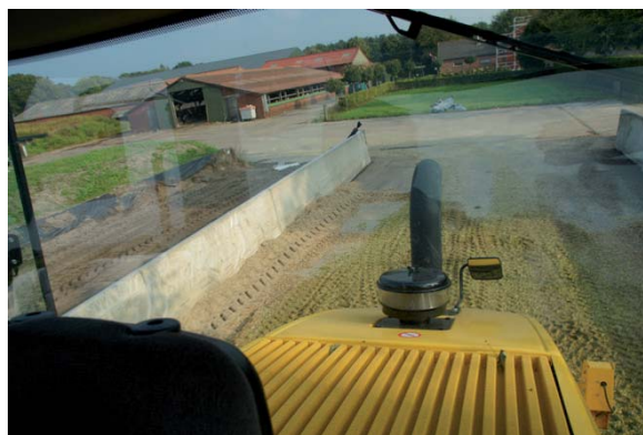
Door het ontbreken van EGR en roetfilters blijft de motorkap bescheiden in hoogte. Vanuit de cabine is er daardoor een goed zicht naar achteren.
