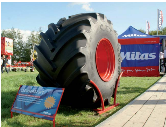
De letterlijk grootste verrassing op bandengebied stond bij Mitas. De 2,02 meter hoge 1290/50R32 SFT heeft een draagvermogen van zestien ton bij 10 km/u. Wel een wat grove nok voor grasland.
