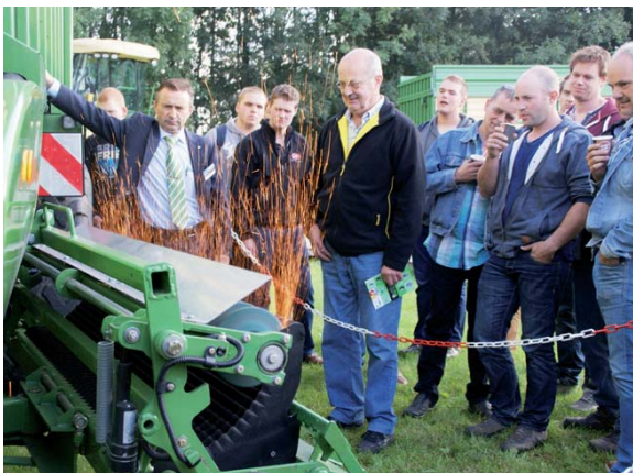
De aandachttrekker bij Krone was het automatisch slijpen van messen met een fraaie, simpele eigen oplossing. Elke dag even snel de messen scherp bespaart volgens onafhankelijk onderzoek dat Krone door DLG liet doen vijftien procent brandstof.
