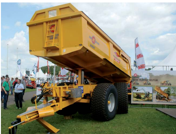
Een gloednieuwe PM2600 van Alasco. Het is een zeven-tienkuubs grond-dumper met een gestuurde achteras en 650/65R30.5-banden. De nieuwe achterklep heeft geïntegreerde cilinders.
