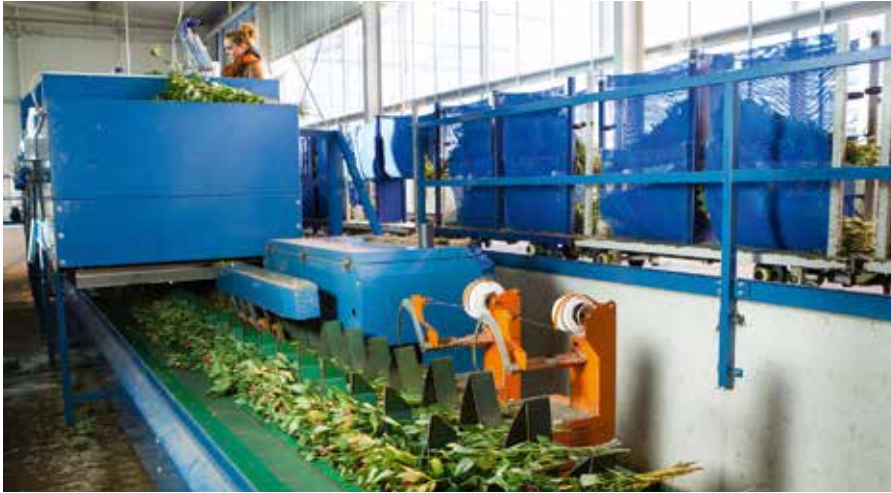
De volautomatische sorteermachine kan snel en nauwkeurig op kwaliteit sorteren. Met een druk op de knop kan de lengte van de stelen en de aantallen per bos worden ingesteld.
