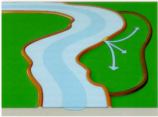
Scenario 1: Noodoverloop is gecontroleerd overstroom
