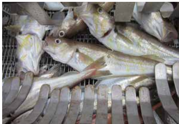
Bij het bedwelmen aan boord gaan de vissen over een negatief geladen band, waarbij ze in contact komen met positief geladen lepels, waardoor ze bewusteloos raken.
