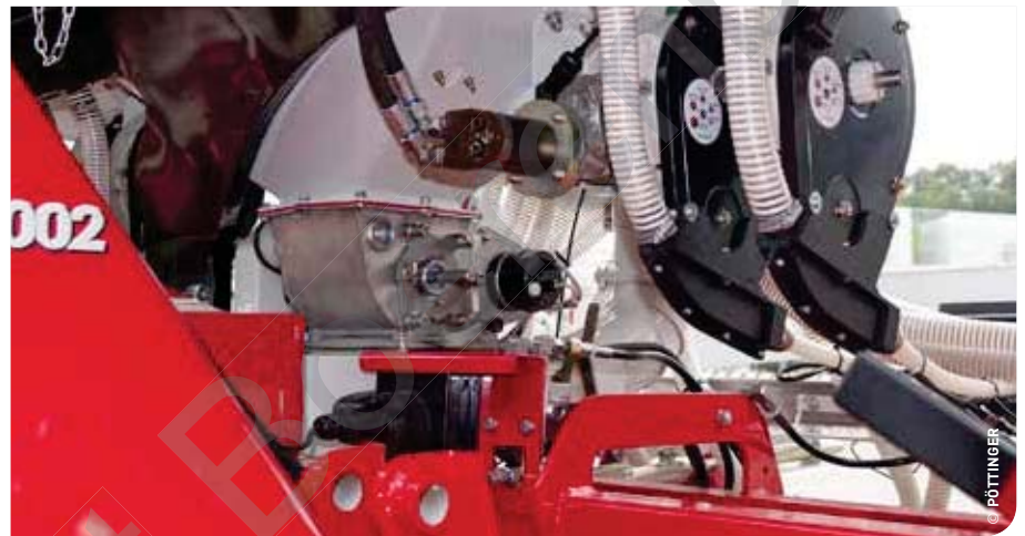
De vernieuwde pneumatische zaaimachine Aerosem is zowel geschikt voor granen als voor maïs. Voor maïs is de enkelkorrelzaai techniek ( precision combi seeding, PCS ) beschikbaar.
