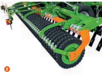
1 De getrokken schijveneg Certos wordt speciaal gebouwd voor grotere werkdieptes omdat men beseft dat de wortelzone moet worden losgewerkt. Het verschil met de klassieke X-schijveneg is nog erg klein. 2 Met deze aandrukrollen kan de bodem worden aangedrukt naargelang de omstandigheden. 3 Aandrukschijven met nokprofiel of (3) gladde ringen voor oppervlakkig aandrukken.
