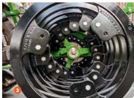
1 De getrokken schijveneg Certos wordt speciaal gebouwd voor grotere werkdieptes omdat men beseft dat de wortelzone moet worden losgewerkt. Het verschil met de klassieke X-schijveneg is nog erg klein. 2 Met deze aandrukrollen kan de bodem worden aangedrukt naargelang de omstandigheden. 3 Aandrukschijven met nokprofiel of (3) gladde ringen voor oppervlakkig aandrukken.
