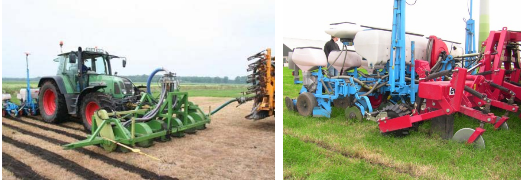
Mais in graszode zaaien met systeem Pol (links) en met de Hunter van Evers-Agro (rechts)
