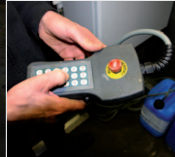
Met behulp van de inleesterminal zijn speenlocaties van koeien die voor het eerst door de robot worden gemolken, gemakkelijk in te lezen.
