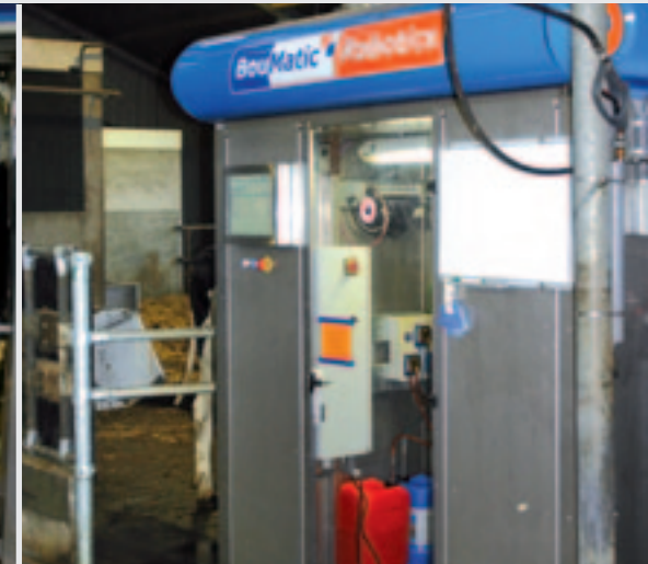
De technische ruimte van de robot bevindt zich achter de koe. Deze is voor de veehouder goed toegankelijk.
