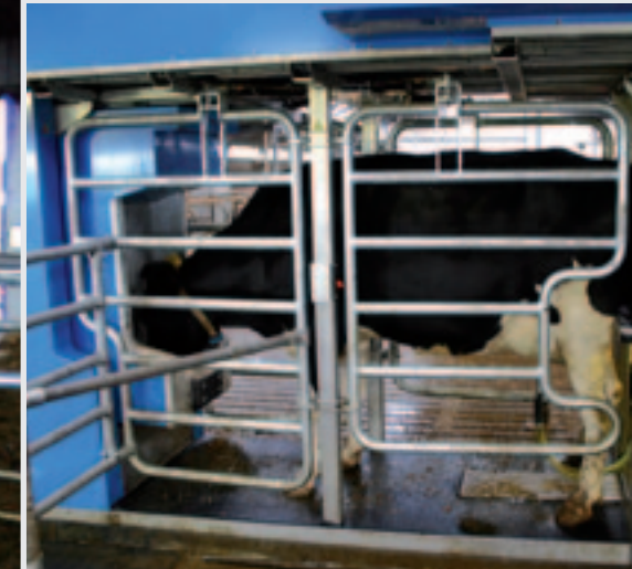
De robot heeft aan beide kanten een in- en een uitgang. Daardoor kan de robot een belangrijke rol spelen bij het koeverkeer in de stal.
