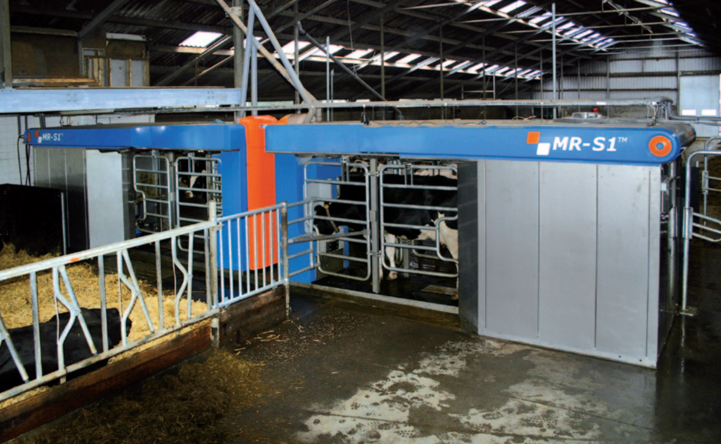
De robot heeft aan beide kanten een in- en een uitgang. Daardoor kan de robot een belangrijke rol spelen bij het koeverkeer in de stal.
