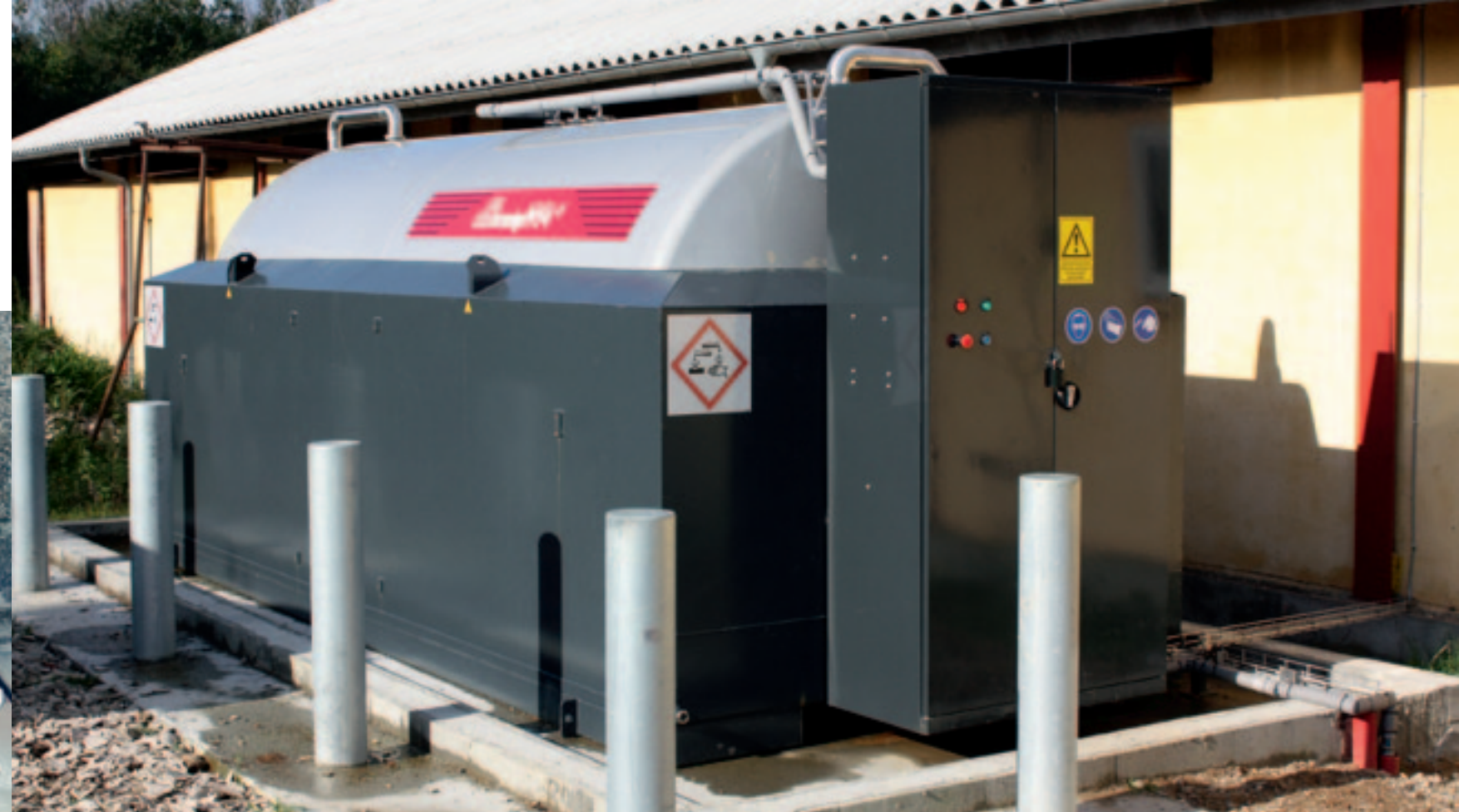
Het Deense JH Agro en Infarm ontwikkelden beide een installatie om mest aan te zuren met anorganisch zuur. De bedrijven geven een zuurverbruik op van 4 tot 8 kg per kuub mest. NMI stelt een verbruik van 7,5 tot 12 kg per ton rundmest afhankelijk van het stikstofgehalte.
