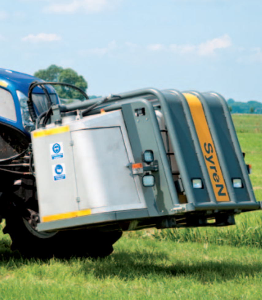
In het kader van Proeftuin Natura 2000 Overijssel werden emissiemetingen gedaan aan een systeem om mest tijdens het uitrijden aan te zuren.
