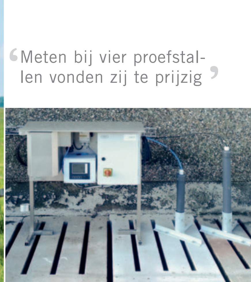
De installaties om mest in een kelder of externe opslag aan te zuren, werken volautomatisch op basis van pH-metingen. De data worden gelogd.
