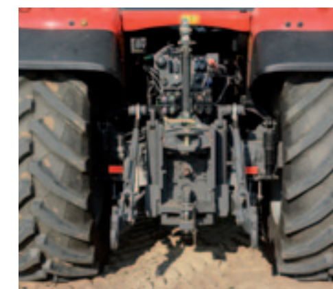
Dankzij de veerpoten is het comfort in de cabine goed. Kieperknobbel en zwaaiende trekhaak zijn standaard.
