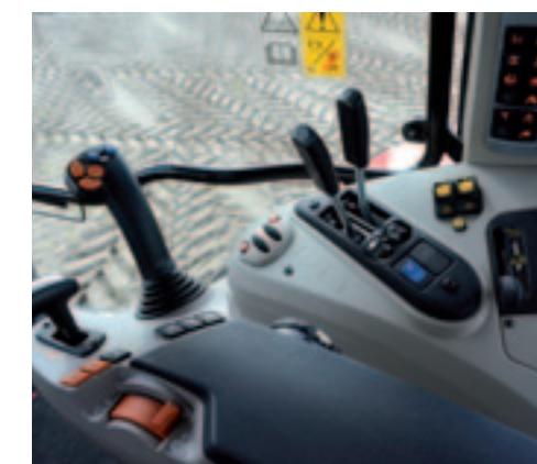
Handgas en transmissiebediening zitten op de armluning. Op het spatbord zitten de hendels voor de mechanisch bediende ventielen.
