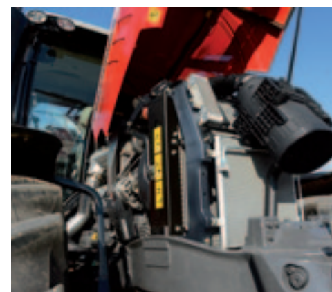
De motorkap gaat in zijn geheel open. Het luchtfilter (rechts) is dan prima bereikbaar en de koelers zijn makkelijk te reinigen.
