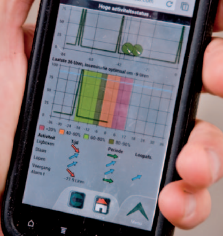
Aan de realtime plaatsbepaling leidt GEA Cowview af hoeveel tijd een dier heeft doorgebracht in de ligboxen, aan het voerhek, hoelang ze stilstond, hoelang ze liep en hoever ze liep in die tijd.
