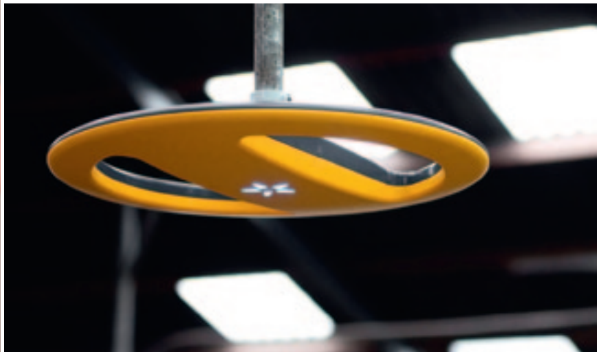
Nedap hangt bakens in de stal om de coördinaten van een individueel dier in de stal te bepalen. De bakens hangen in een denkbeeldig raster op maximaal 20 meter van elkaar. De bakens zijn niet met de procescomputer verbonden.
